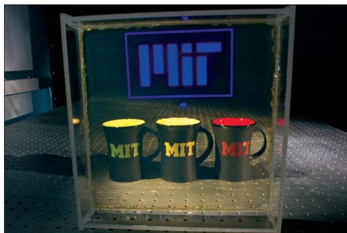
Nanopartikel reflektieren bestimmte Wellenlängenbereiche und stellen auf diese Weise Bilder dar.
